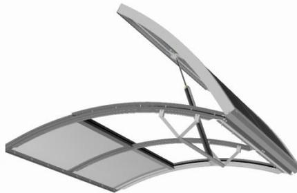
a. mit Öffnungsflügel - als **RWA- Gerät** mit pneumatischem Öffnungszylinder kombiniert mit einem E-Motor 230V (Hub 300/500mm)
